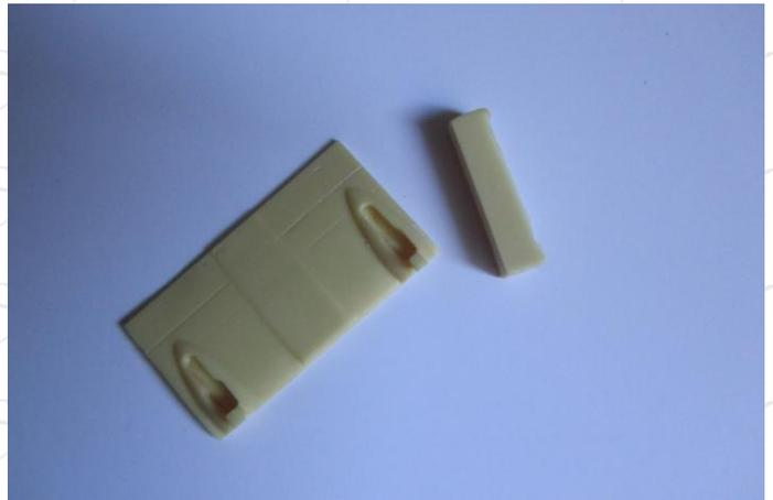
Un ponçage est souvent nécessaire pour obtenir des pièces prêtes à être collées. Utilisez pour cela diverses tailles de papier de carrossier.
